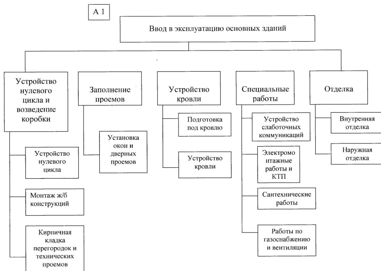
Рисунок 3.5. Инфраструктура комплекса и структура работ (часть 2)
